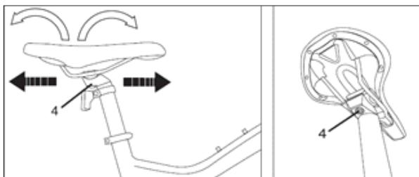
Можно регулировать угол наклона седла и двигать его вперед или назад.
